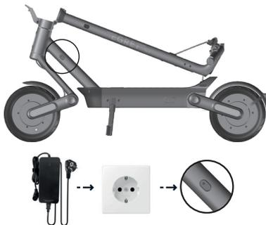
2. Öffne die Schutzkappe der Ladebuchse und verbinde das Ladekabel mit dem ausgeschalteten E-Scooter.
